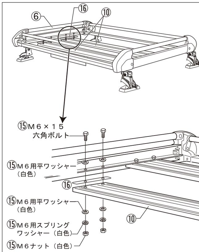
(1)横枠 Assy ⑥と床板⑩の間にパット⑬を入れ、M6×15六角ボルト⑮、M6用平ワッシャー⑮（白色）、M6用スプリングワッシャー⑮（白色）、M6ナット⑮（白色）で締付け、固定します。（8ヶ所）
