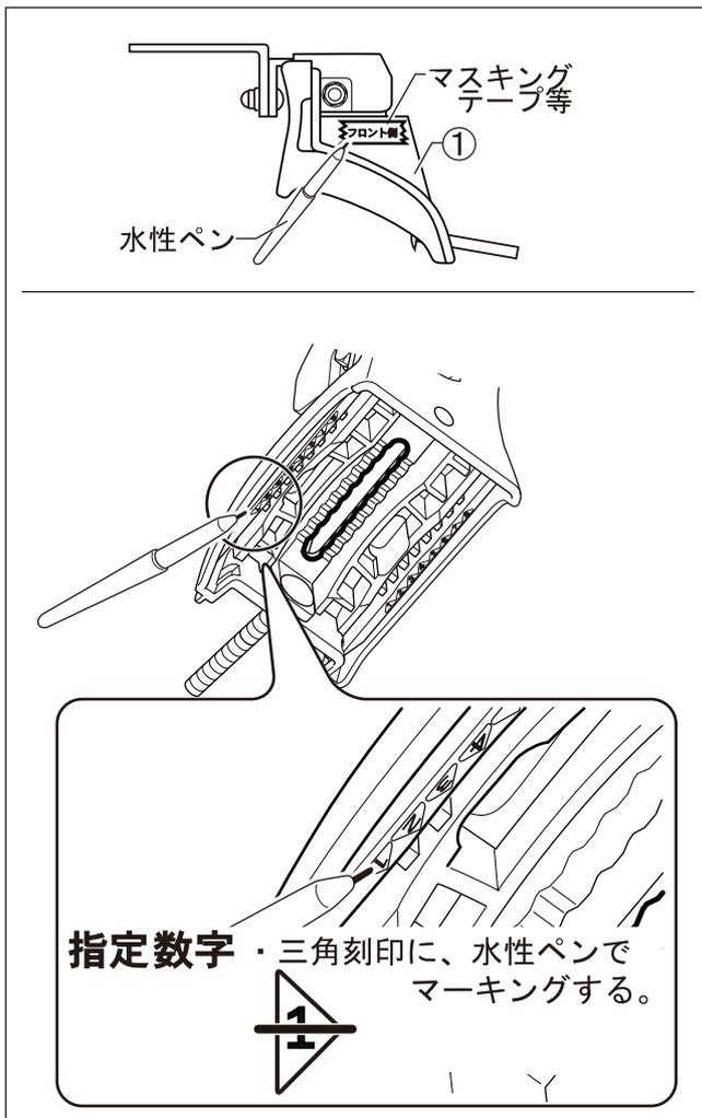
(1)脚 Assy ①にフロント、リヤの識別がわかるようにマスクングテープ等に水性ペンで印を付けます。
