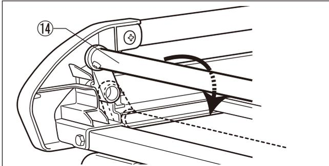
(1)積載物に応じて、前後枠パイプ⑭の位置を変えてください。
