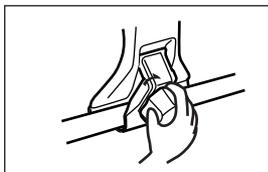
各締付部は、ユルミが発生するおそれがあります。ユルミが発生しますと、ルーフキャリアの脱落、車両の破損等の事故の原因となりますので、本書記載の指定トルクを参考に固定をし、更に定期的（100km走行毎を目安）にボルト類の締付け具合及び吊金具等の掛かり具合を点検し、必要に応じて増締めをしてください。特に悪路、高速走行前後には、必ず点検してください。
