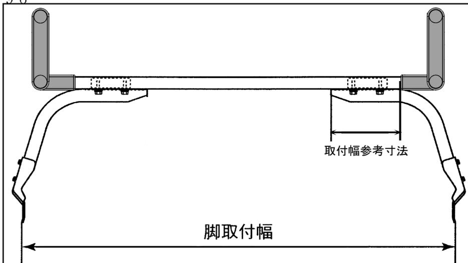
**1** 取付幅と取付幅参考寸法を測定し「脚 ASSY」の位置を固定します。
