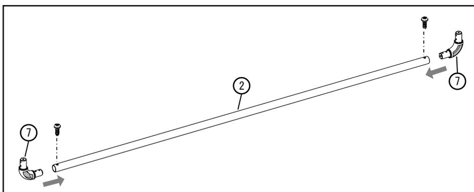
**3** 残り1本の前後枠パイプ②の両端部にコーナーエルボ⑦を差込み、M5×16 ナベ小タッピングネジ⑬で固定します。
