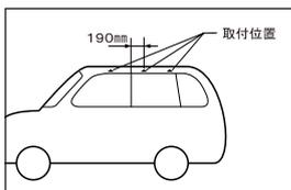
ルーフキャリアを取付指定位置以外に取付けると、固定力不足によりルーフキャリアが脱落し、後続車や人を事故に巻き込む恐れがあります。必ず、取付指定位置に取付けてください。
