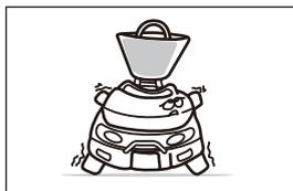
本製品の最大積載重量は 50kg までです。最大積載量を超えた積載をしますと、ルーフキャリア及び車両の破損、過積載による荷物の脱落等の事故の原因となりますので、最大積載量は必ず守ってください。
