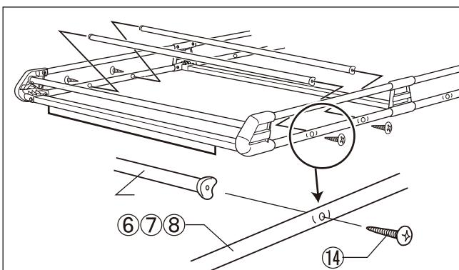
(1) 中間パイプ⑤を、M6×43丸皿タッピングネジ⑭で締付け、固定します。
