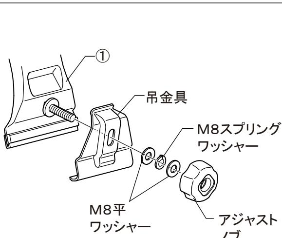
(1) 脚 Assy①から、アジャストノブ、M8平ワッシャー、M8スプリングワッシャー、吊金具を外します。
