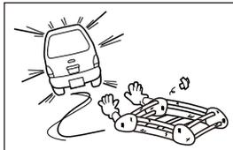
法定速度を超えた連続高速走行や強風時の連続走行・悪路走行をしますと、各締付け部のボルト類のユルミが発生し、ルーフキャリアが脱落し、後続車や人を事故に巻き込むおそれがあります。
