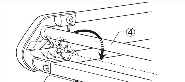
(1)積載物に応じて、前後枠パイプ④の位置を変えてください。
