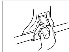
各締付部は、ユルミが発生するおそれがあります。ユルミが発生しますと、ルーフキャリアの脱落、車両の破損等の事故の原因となりますので、本書記載の指定トルクを参考に固定をし、更に定期的（100km走行毎を目安）にボルト類の締付け具合及び吊金具等の掛け具合を点検し、必要に応じて増締めをしてください。特に悪路、高速走行前後には、必ず点検してください。
