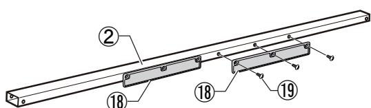
(1) フレーム角パイプ②(フロント用)の側面部に左図の要領でフラップ⑯2個をM5×12トラスネジ⑲で取付けます。
