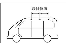
ルーフキャリアを取付指定位置以外に取付けると、固定力不足によりルーフキャリアが脱落し、後続車や人を事故に巻き込むおそれがあります。ルーフキャリアは、必ず取付指定位置に取付けてください。
