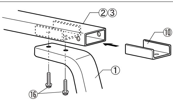
(1) フレーム角パイプ②③にスライド金具⑩を差し込み、脚①をM6×20セムスボルト⑯で仮組みします。 (20ヶ所)
