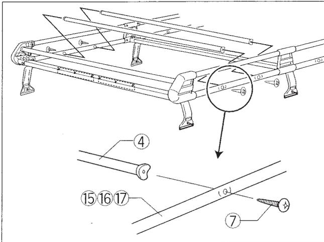
(1) 中間パイプ④を、M6×4 3丸皿タッピングネジ⑦で締付け、固定します。
