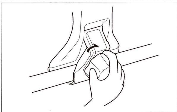
各締付部は、ユルミが発生するおそれがあります。ユルミが発生しますと、ルーフキャリアの脱落、車両の破損等の事故の原因となりますので、本書記載の指定トルクを参考に固定をし、更に定期的（100km走行毎を目安）にボルト類の締付け具合及び吊金具等の掛かり具合を点検し、必要に応じて増締めをしてください。
