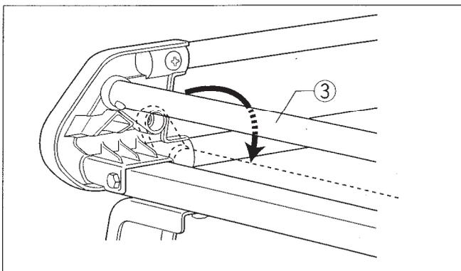
(1)積載物に応じて、前後枠パイプ③の位置を変えてください。
